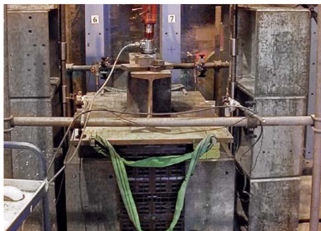
Horizontalios (iš šono) apkrovos bandymas
